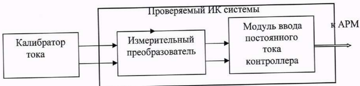
Рисунок 1 - Схема проверки погрешности каналов измерения силы постоянного тока системы
