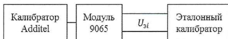
Рисунок 1 – Схема подключения для определения основной погрешности калибратора в режиме измерений напряжения постоянного тока
