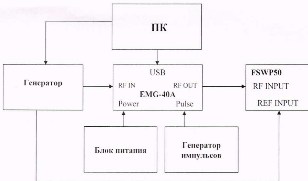
Рисунок 5 – Структурная схема соединения СИ для определения параметров импульсной модуляции
