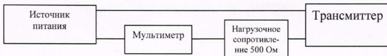
Рисунок 1 – Структурная электрическая схема подключения трансмиттера
