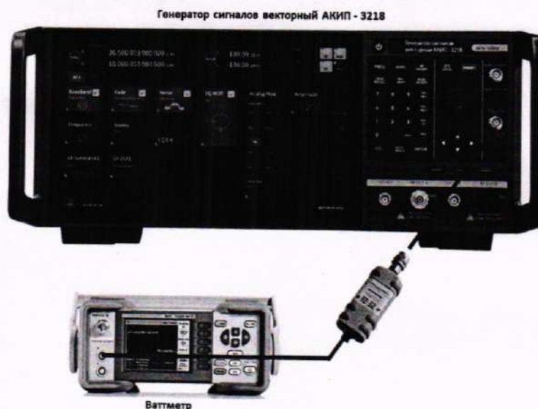
Рисунок 7 – Схема соединения приборов для определения абсолютной погрешности установки размаха синусоидального сигнала 5 Вп-п
