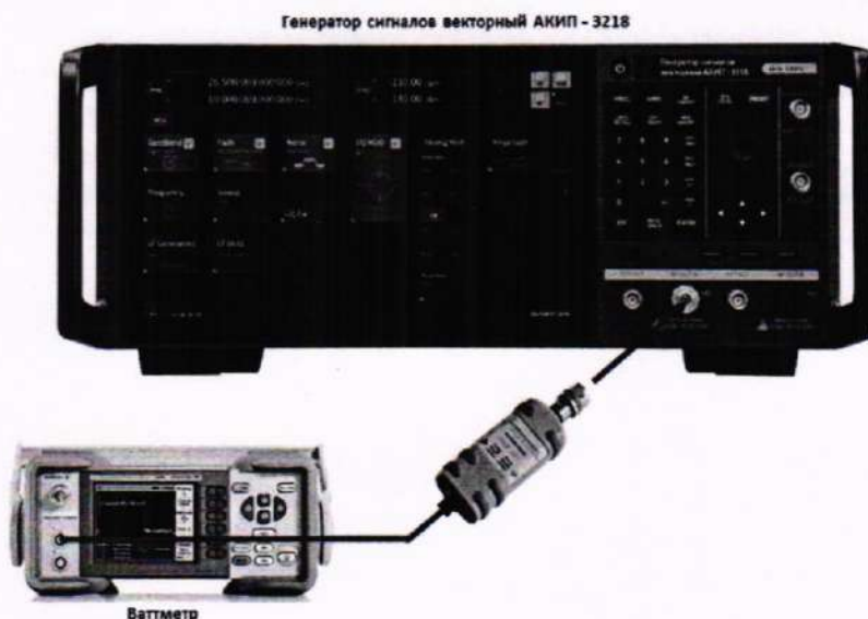
Рисунок 1 – Схема соединения приборов для определения абсолютной погрешности установки максимального уровня выходного сигнала
