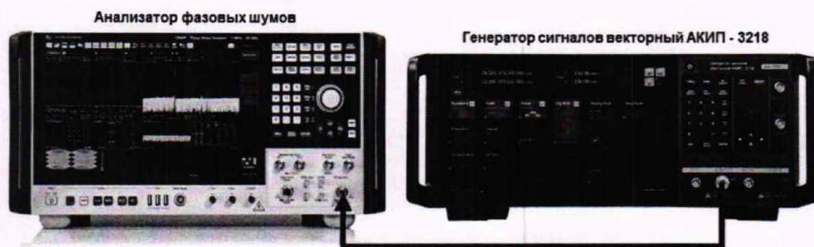
Рисунок 5 – Схема подключения для измерения фазовых шумов с помощью анализатора фазовых шумов FSWP26
