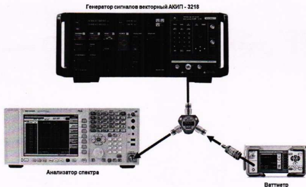
Рисунок 2 – Схема соединения приборов для определения частотной зависимости затухания кабеля
