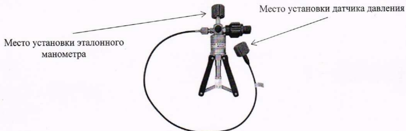
Рисунок Б.5 – Схема установки эталонного манометра и датчика давления для измерений давления сжатого воздуха в пневматических тормозных системах стендов тормозных силовых Cosber.
