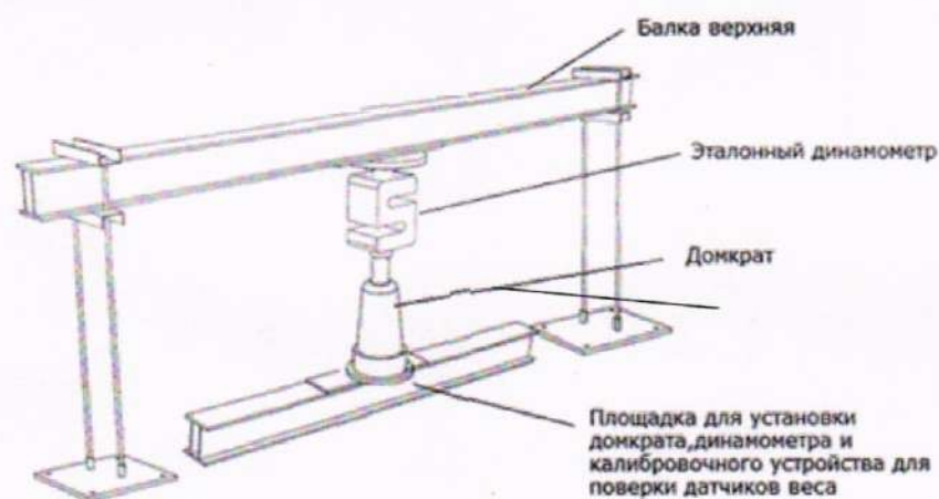
Рисунок Б.3 – Схема установки калибровочного устройства для измерения массы транспортного средства, приходящейся на ось, для левого и правого блоков роликов для стендов тормозных силовых Cosber
