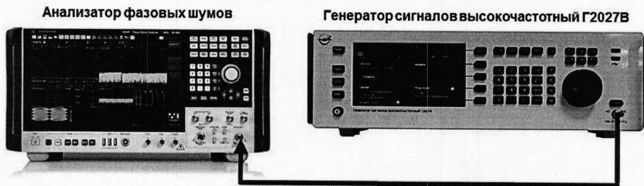
Рисунок 5 – Схема подключения для измерения фазовых шумов с помощью анализатора фазовых шумов FSWP26
