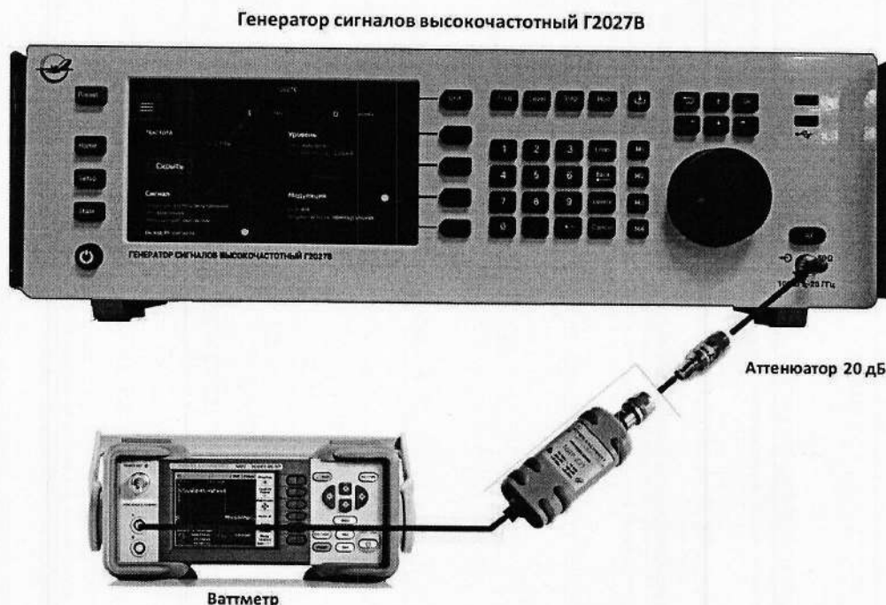
Рисунок 1 – Схема соединения приборов для определения абсолютной погрешности установки максимального уровня выходного сигнала
