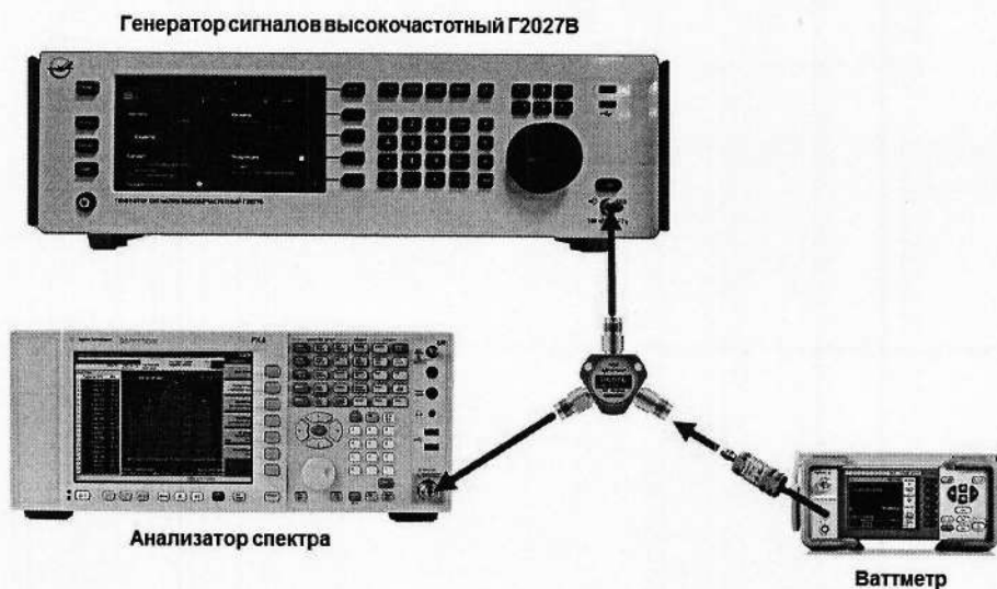
Рисунок 2 – Схема соединения приборов для определения частотной зависимости затухания кабеля
