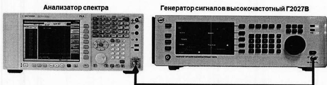
Рисунок 4 – Определение параметров спектра сигнала в режиме непрерывных колебаний
