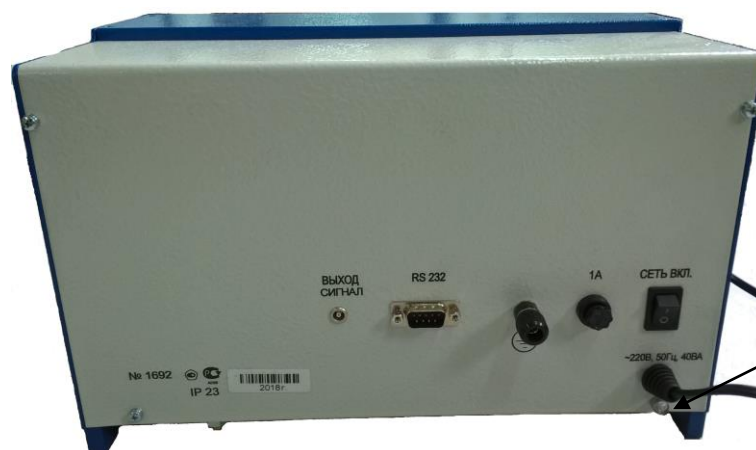
Рисунок 3 – Схема пломбировки от несанкционированного доступа
