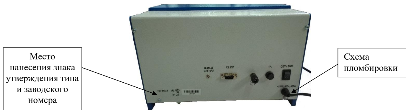
Рисунок 3 – Место нанесения знака утверждения типа, заводского номера и схема пломбировки от несанкционированного доступа
