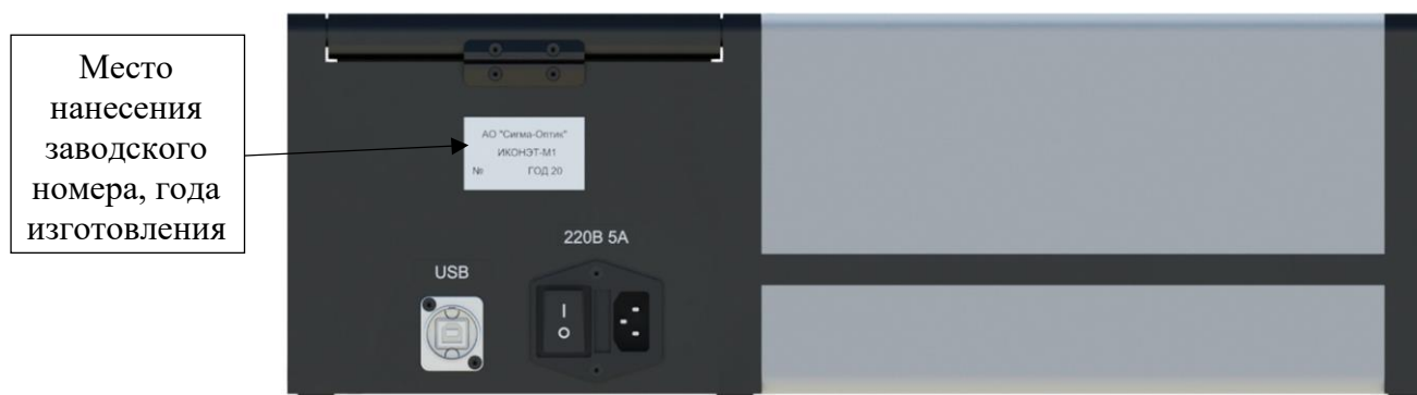
Рисунок 4 – Вид задней панели спиртомера ИКОНЭТ-М1. Место нанесения заводского номера спиртомеров, года изготовления
