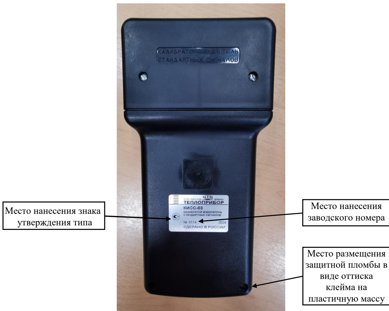
Рисунок 2 – Места нанесения заводского номера, нанесения знака утверждения типа и пломбирования приборов от несанкционированного доступа
