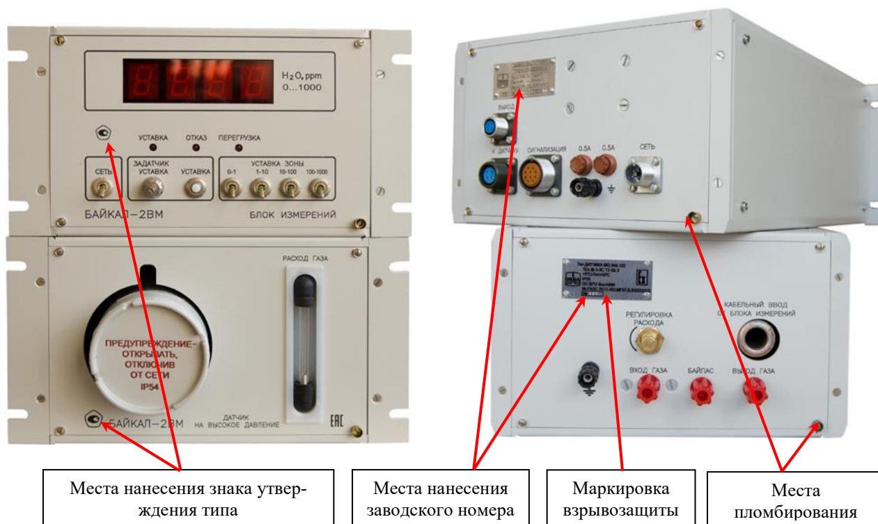
Рисунок 1 – Внешний вид гигрометра кулонометрического БАЙКАЛ-2ВМ с указанием мест нанесения знака утверждения типа, заводского номера мест пломбирования и маркировки взрывозащиты.
