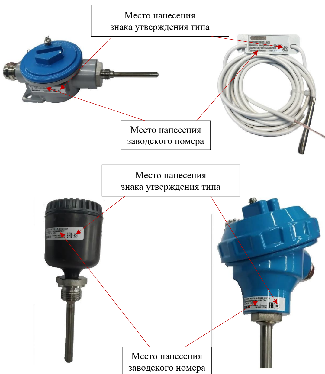
Рисунок 4 – Место нанесения заводского номера и знака утверждения типа
