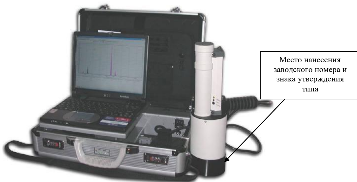
Рисунок 1 – Внешний вид анализаторов рентгенофлуоресцентных энергодисперсионных «Призма - М(Au)» в переносном варианте исполнения
