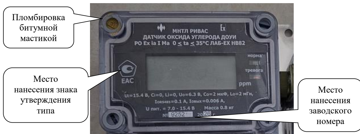
Рисунок 3 – Общий вид маркировочной таблички, расположенной на передней панели корпуса электронного блока, место пломбировки от несанкционированного доступа битумной мастикой, место нанесения заводского номера и место нанесения знака утверждения типа
