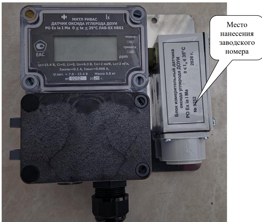
Рисунок 1 – Общий вид датчика, место нанесения заводского номера на маркировочную табличку, расположенную на передней панели измерительного блока
