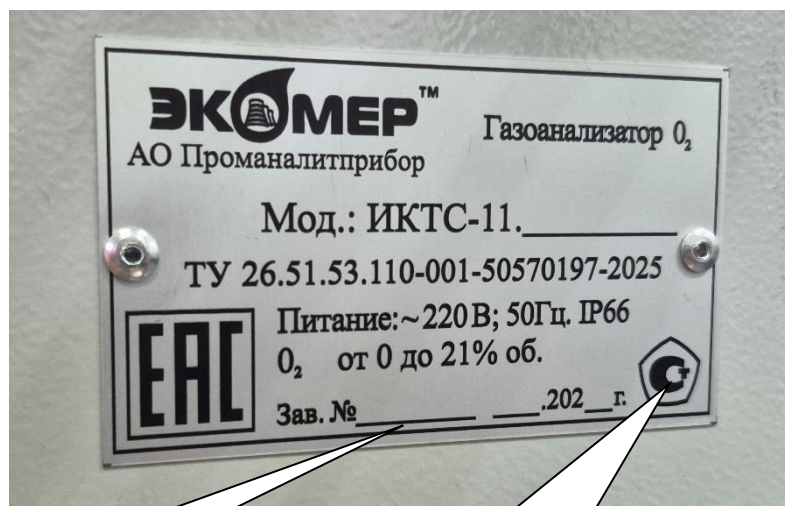
Рисунок 4 – Место нанесения пломбы на корпусе контроллера для исполнений ИКТС-11 и ИКТС-11.1
