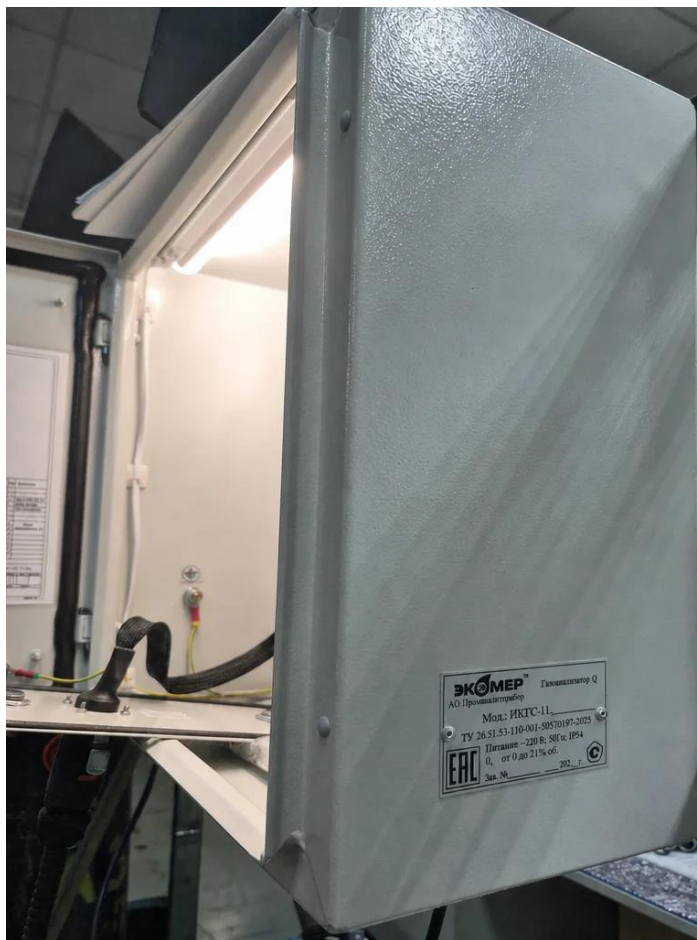
Рисунок 6 – Место крепления планки фирменной для газоанализаторов исполнений ИКТС-11 и ИКТС-11.1
