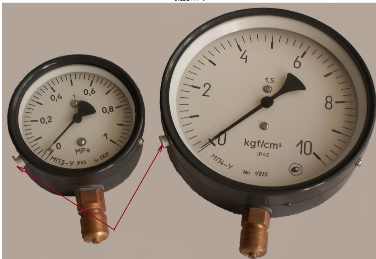
Рис. 2. Места пломбировки приборов
