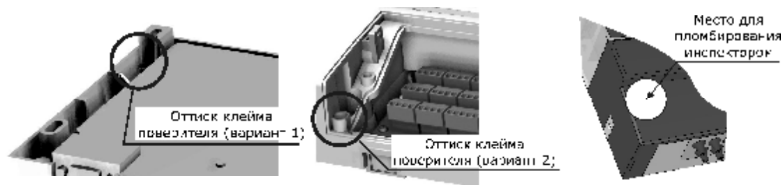
Рисунок 3 – Места пломбирования тепловычислителя
