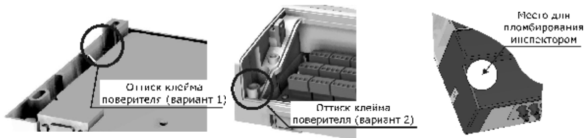
Рисунок 3 – Места пломбирования тепловычислителя
