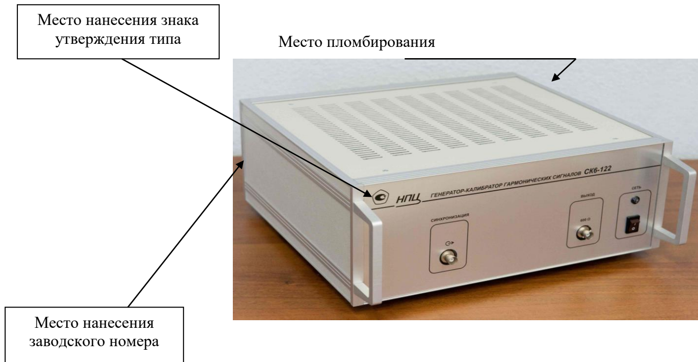
Рисунок 1 – Общий вид генератора-калибратора гармонических сигналов СК6-122, место пломбировки, место нанесения знака утверждения типа и заводского номера
