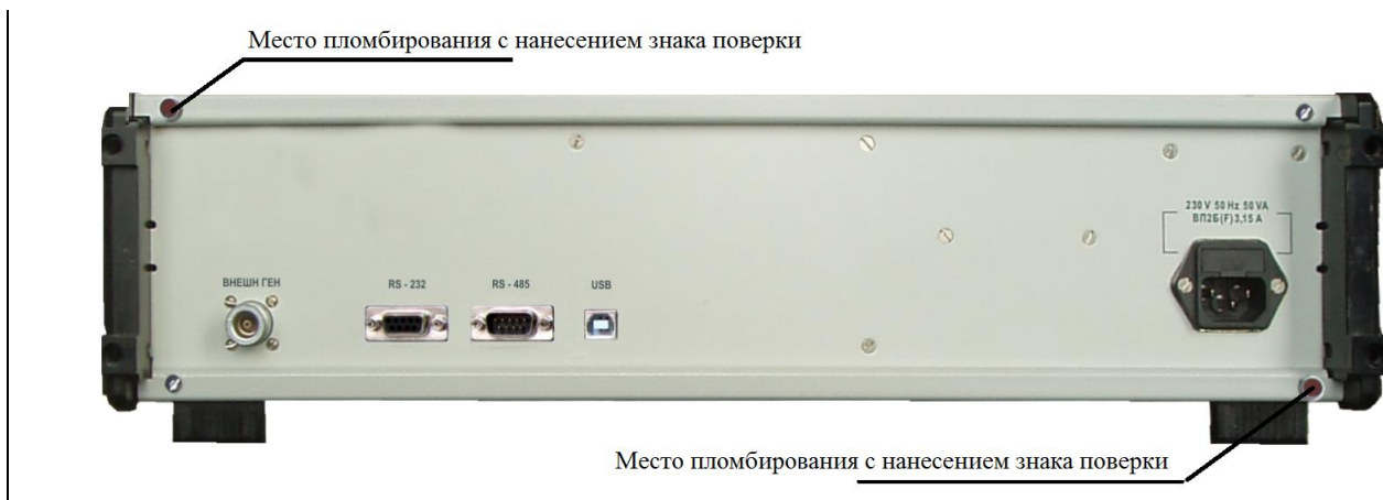
Рисунок 2 – Схема пломбирования от несанкционированного доступа.
