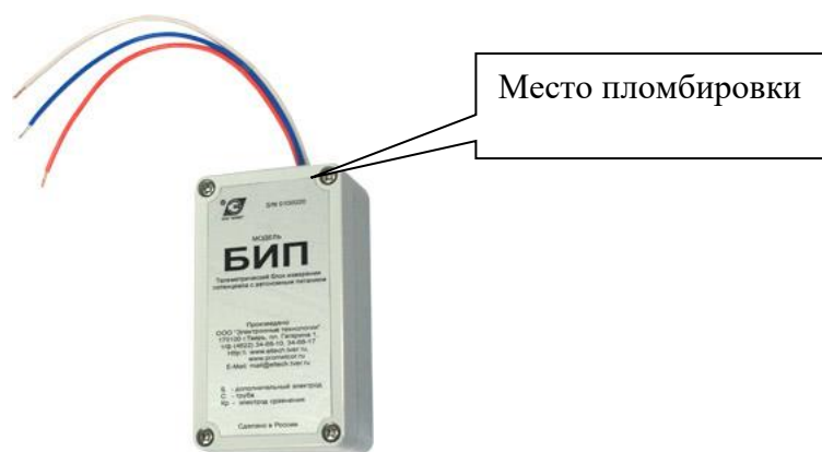
Рисунок 1 – Внешний вид измерителей БИП-01
