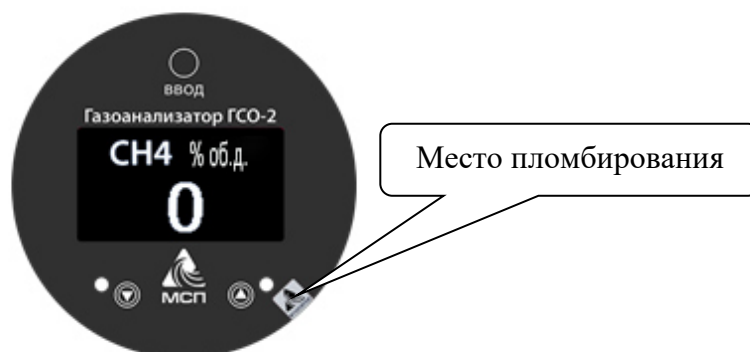
Рисунок 4 – Место пломбирования газоанализаторов стационарных ГСО-2
