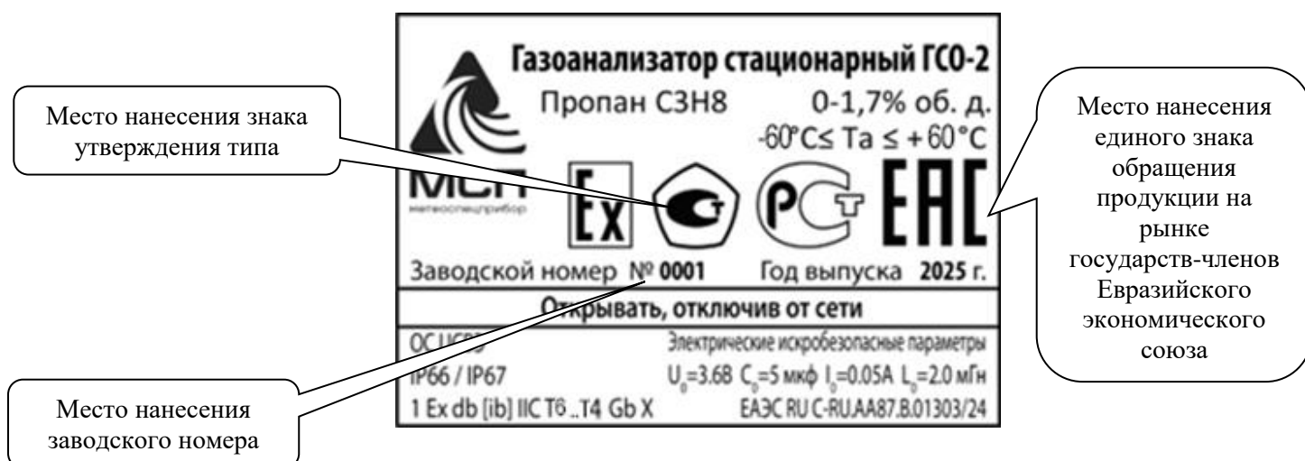
Рисунок 5 – Общий вид таблички, расположенной на корпусе газоанализатора стационарного ГСО-2
