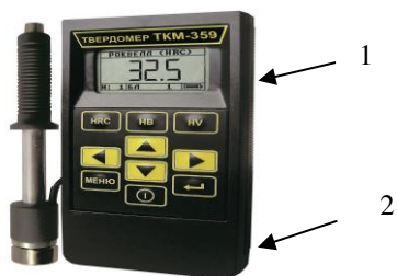
Рисунок 3 – схема пломбировки модификации ТКМ-359М 1,2-места пломбировки
