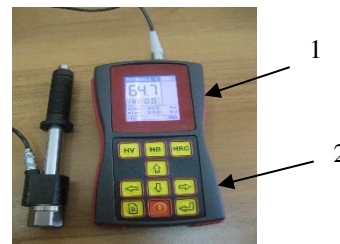
Рисунок 4 – схема пломбировки модификации ТКМ-359С 1,2 - места пломбировки
