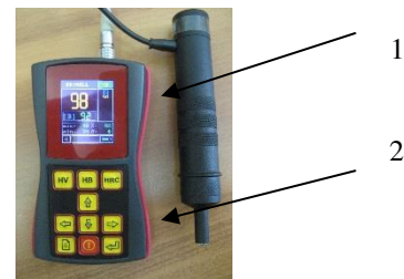
Рисунок 4 – схема пломбировки модификации ТКМ-459С 1,2 - места пломбировки
