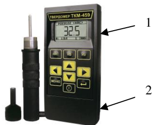
Рисунок 3 – схема пломбировки модификации ТКМ-459М 1,2-места пломбировки
