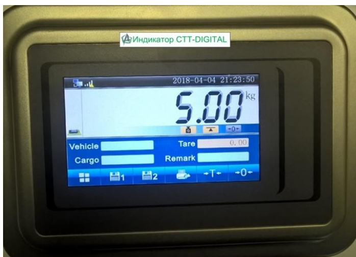
Рисунок 14 – Внешний вид индикатора СТТ-DIGITAL
