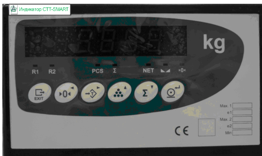
Рисунок 12 – Внешний вид индикатора СТТ-SMART
