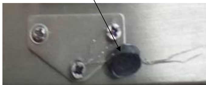
Рисунок 3 – Схема пломбировки от несанкционированного доступа и обозначение места нанесения знака поверки индикатора СТТ-А
