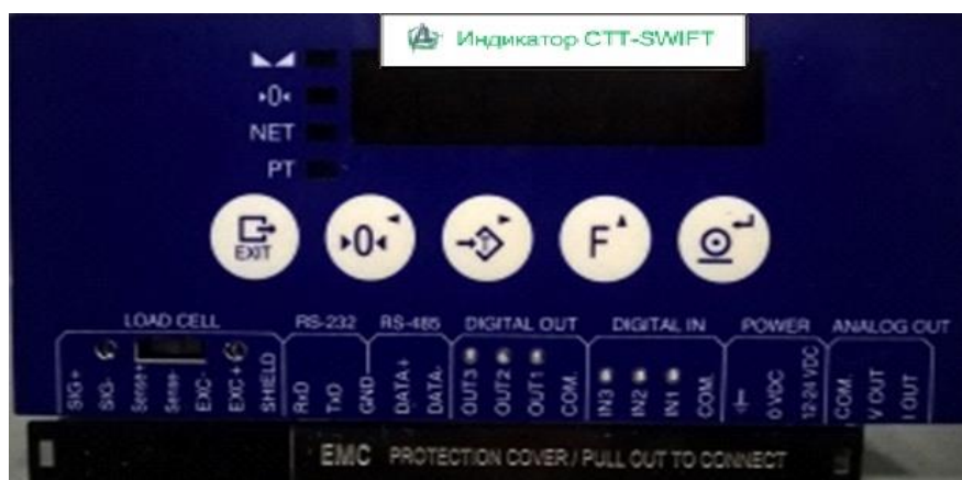
Рисунок 13 – Внешний вид индикаторов СТТ-SWIFT
