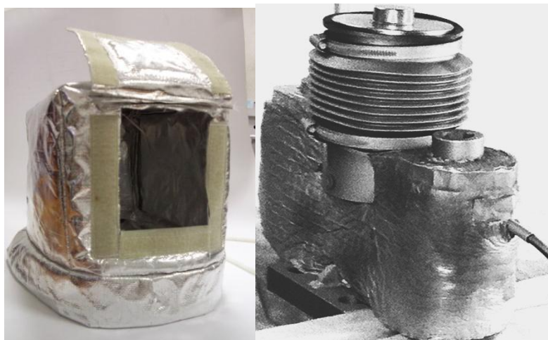
Рисунок 1 – Весоизмерительный датчик оснащенный термочехлом
