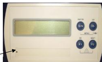
Рисунок 8 – Схема пломбировки от несанкционированного доступа и обозначение места нанесения знака поверки индикатора СТТ-DIGITAL
