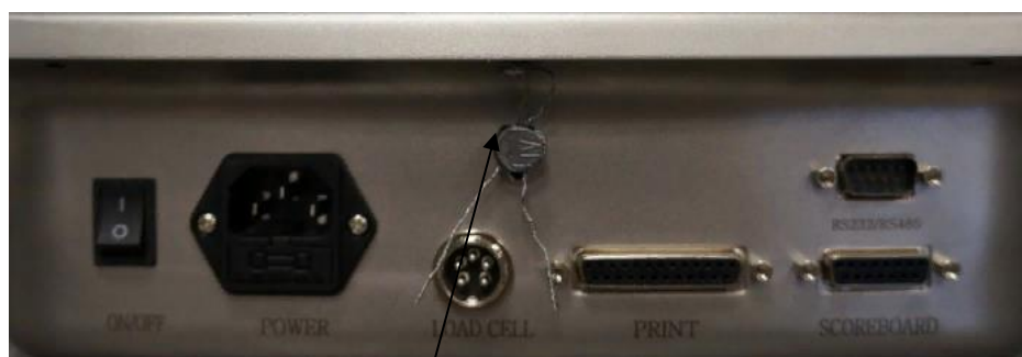
Рисунок 7 – Схема пломбировки от несанкционированного доступа и обозначение места нанесения знака поверки индикатора СТТ-SWIFT
