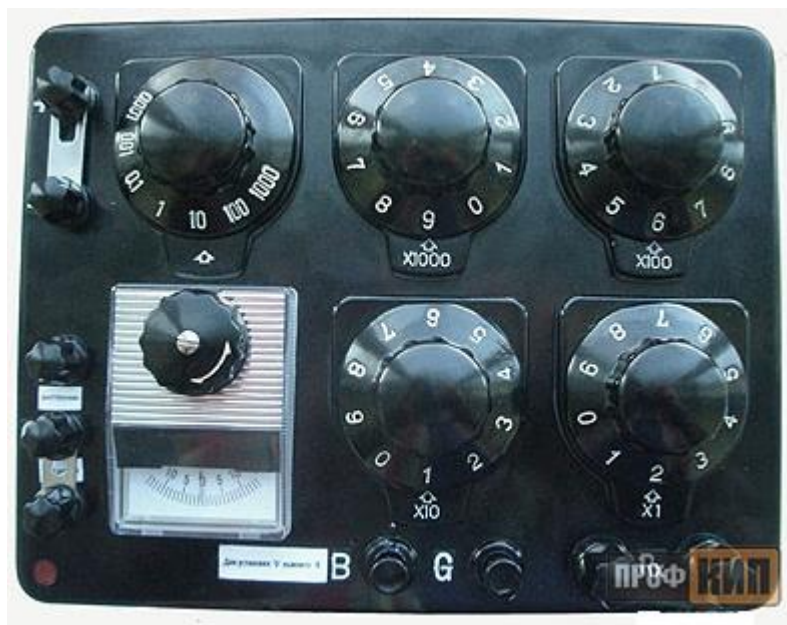
Рисунок 1 – Общий вид моста измерительного ПрофКип Р333-М1
