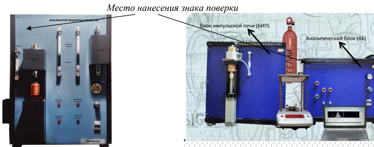
А -Исполнение 1: Моноблок (импульсная печь + аналитический блок)
