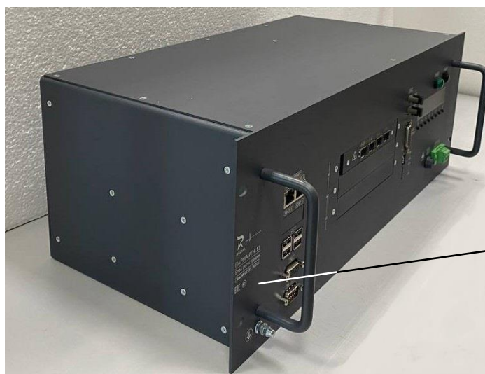
Рисунок 5 – Общий вид блока регистрации высотой 4U из состава регистраторов «Исполнение 2» с указанием места нанесения знака поверки, знака утверждения типа и заводского номера
