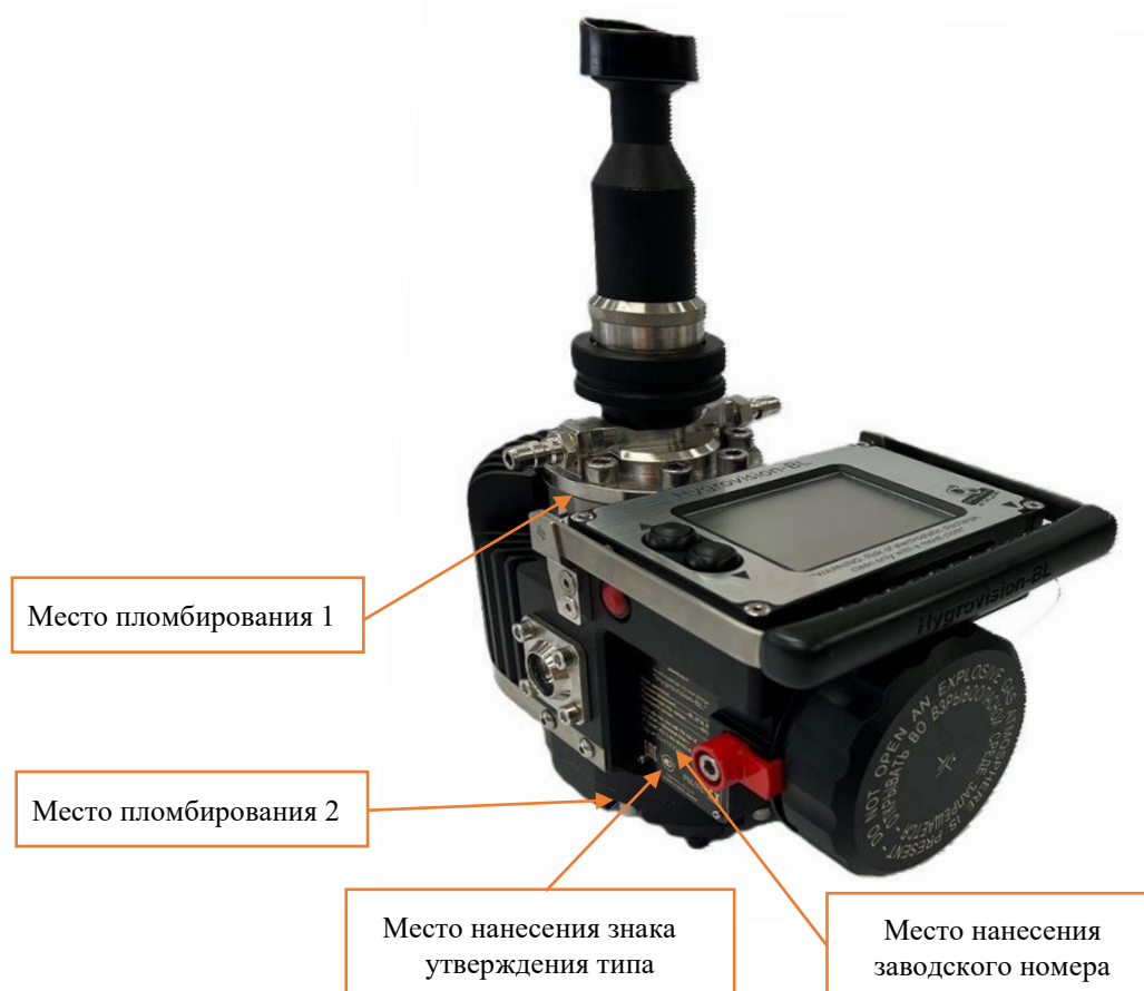
Рисунок 1 – Общий вид анализатора с указанием мест пломбировки, мест нанесения знака утверждения типа и заводского номера
