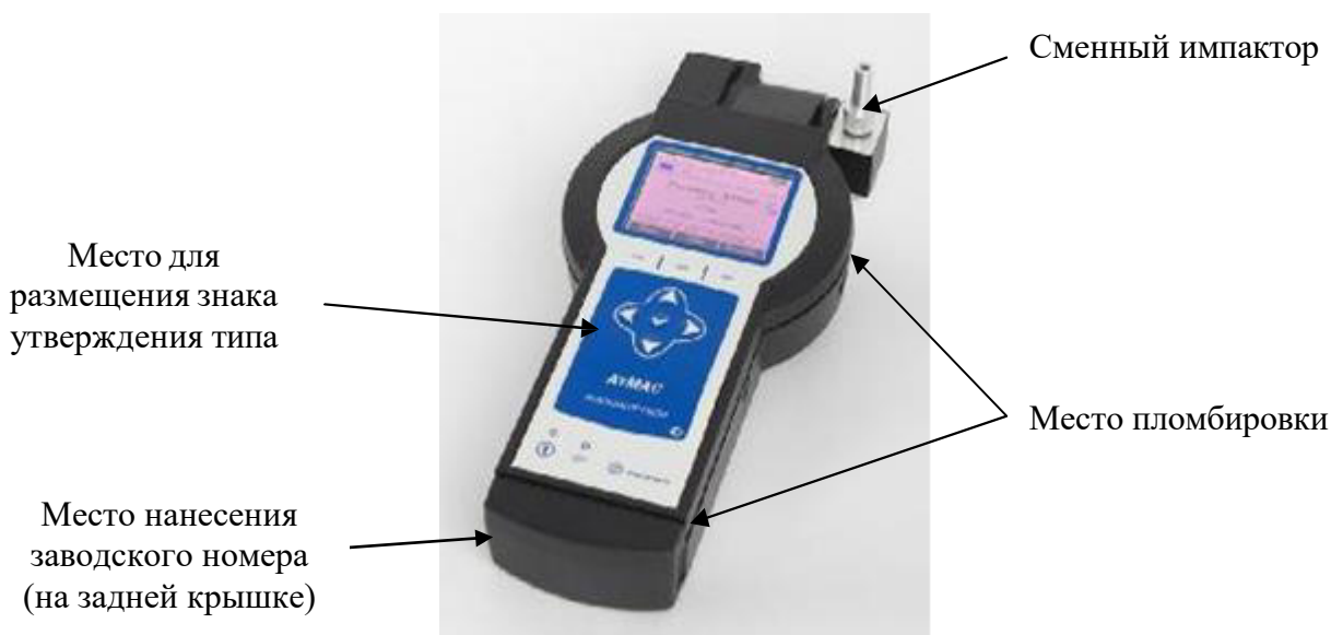
Рисунок 1 – Внешний вид анализатора пыли Атмас, обозначение места для размещения знака утверждения типа, заводского номера и схема пломбировки от несанкционированного доступа
