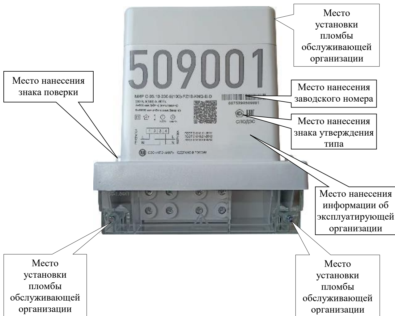
Рисунок 11 – Общий вид счетчиков МИР С-05 наружной установки с отсеком для установки модуля интерфейсного и схемы пломбировки от несанкционированного доступа, обозначение мест нанесения заводского номера, знаков поверки и утверждения типа
