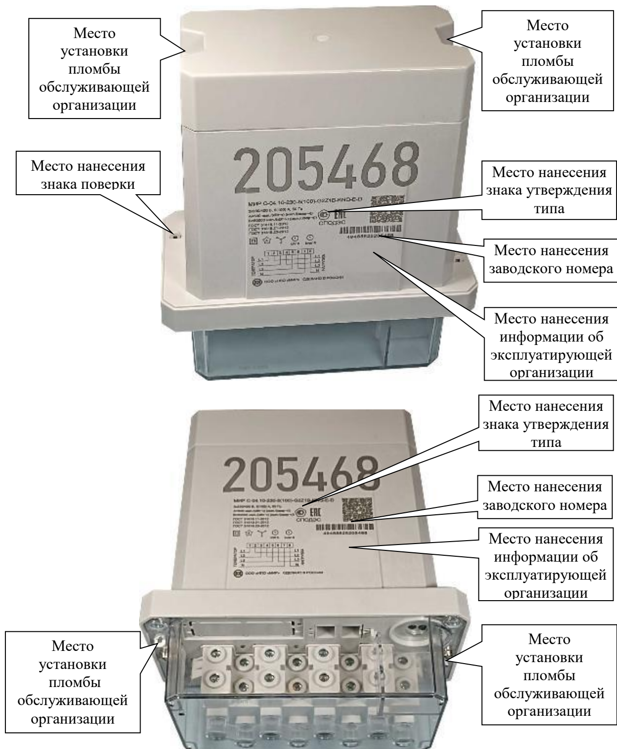
Рисунок 7 – Общий вид счетчиков МИР С-04 наружной установки с отсеком для установки модуля интерфейсного и схемы пломбировки от несанкционированного доступа, обозначение мест нанесения заводского номера, знаков поверки и утверждения типа
