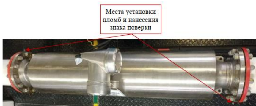
Рисунок 2 – Места нанесения знака поверки и места установки пломб
