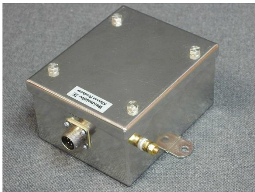
Рисунок 1 – Внешний вид усилителя УЗ-002
