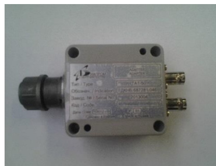
Рисунок 4 – Внешний вид адаптера ТА1-12
