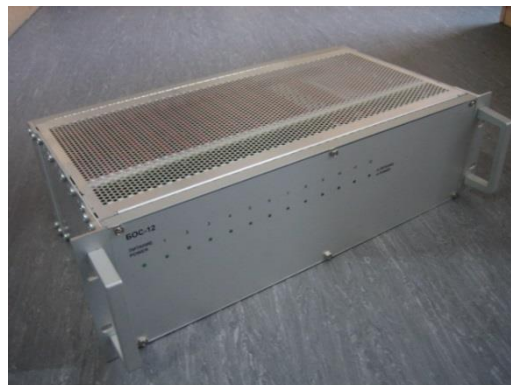
Рисунок 2 – Внешний вид блока объединительного БОС-12
