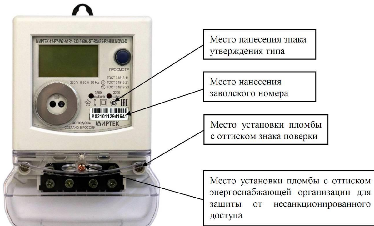
Рисунок 2 – Общий вид счетчика в корпусе типа W2
