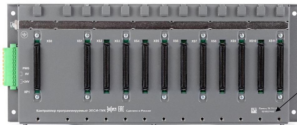
Рисунок 2 – Общий вид коммутационной панели с указанием места нанесения заводского номера
