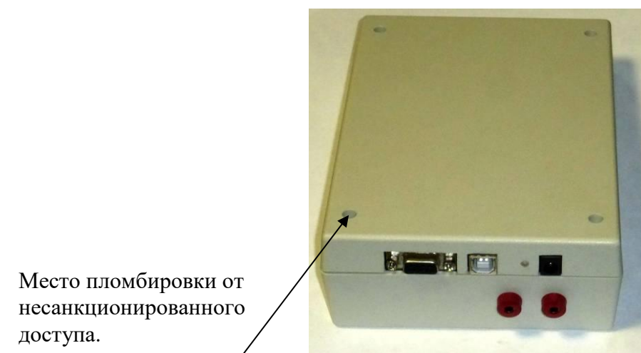
Рисунок 2 – Место пломбировки от несанкционированного доступа
