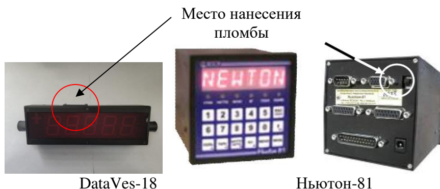
Рисунок 2 – Общий вид приборов и схемы их пломбирования
