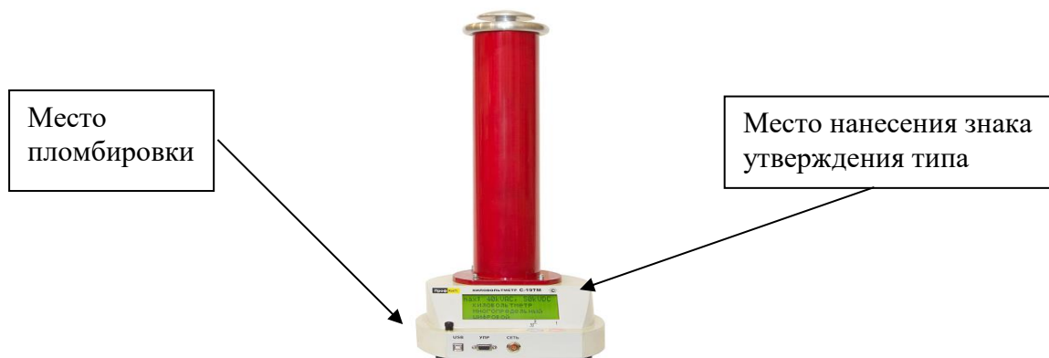
Рисунок 1 – Общий вид киловольтметра, места пломбировки и нанесения знака утверждения типа
