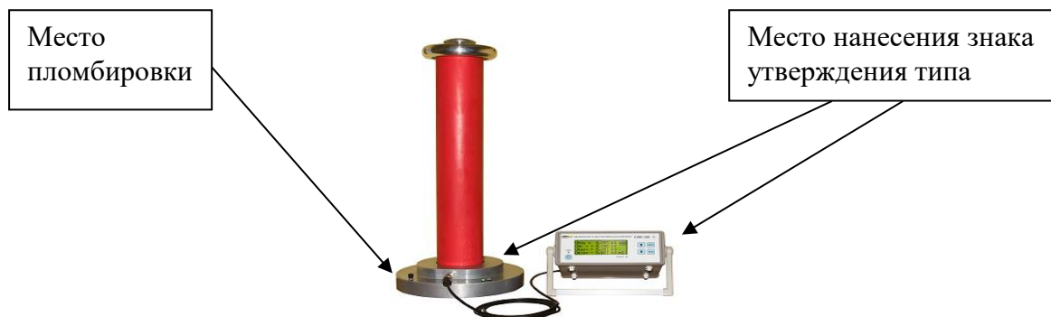
Рисунок 1 – Общий вид киловольтметра, места пломбировки и нанесения знака утверждения типа
