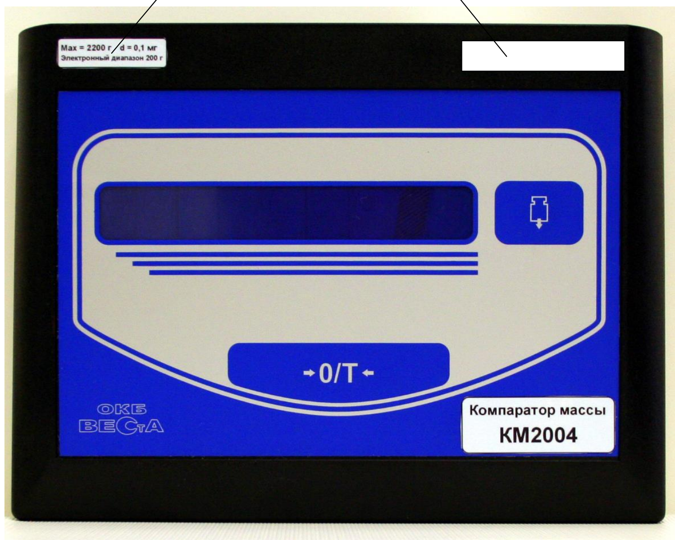
Рисунок 2 – Расположение табличек с маркировкой, защитной наклейки и знака поверки на электронном блоке
