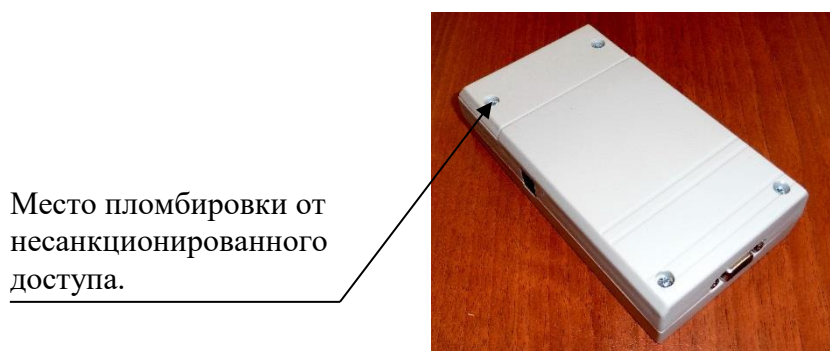
Рисунок 2 – Место пломбировки от несанкционированного доступа
