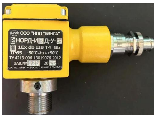
Рисунок 3 – Общий вид датчиков магнитоиндукционных НОРД-И2Д-У преобразователей расхода турбинных НОРД, МИГ-М
