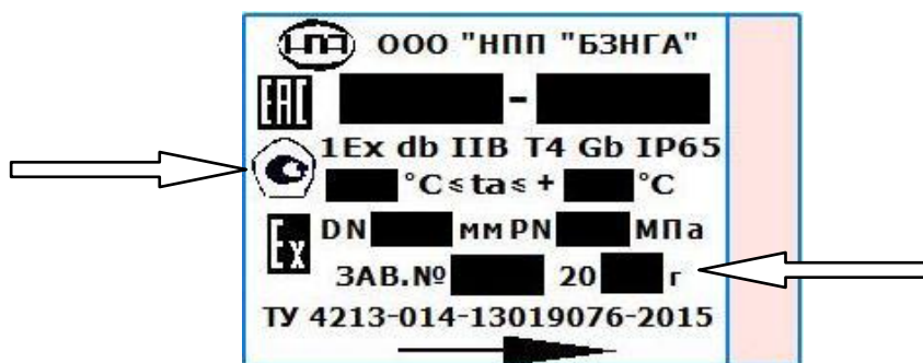
Рисунок 5 – Обозначения мест нанесения знака утверждения типа и заводского номера
