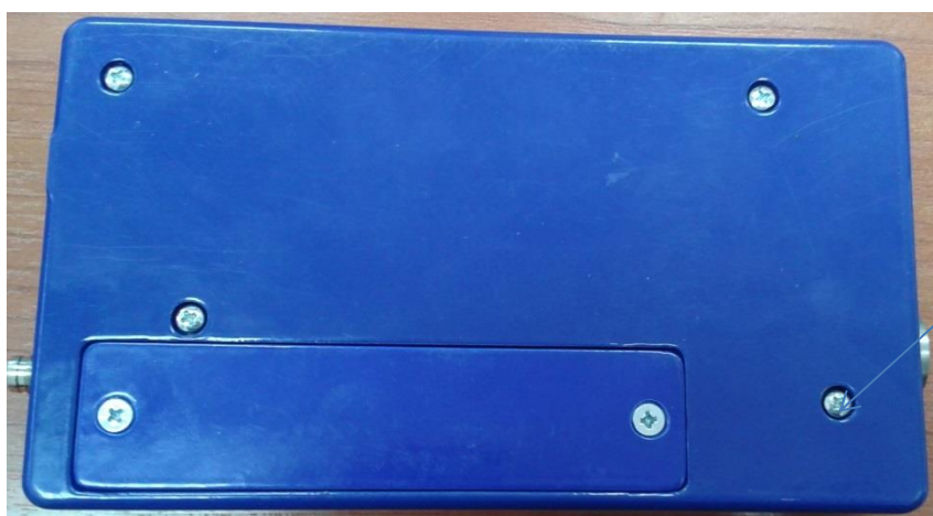
Рисунок 2 – Задняя сторона измерительного блока с местом пломбирования
