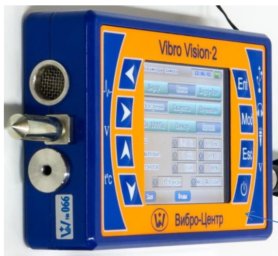
Рисунок 1 – Внешний вид измерительного блока анализатора вибрации «Vibro Vision - 2»
