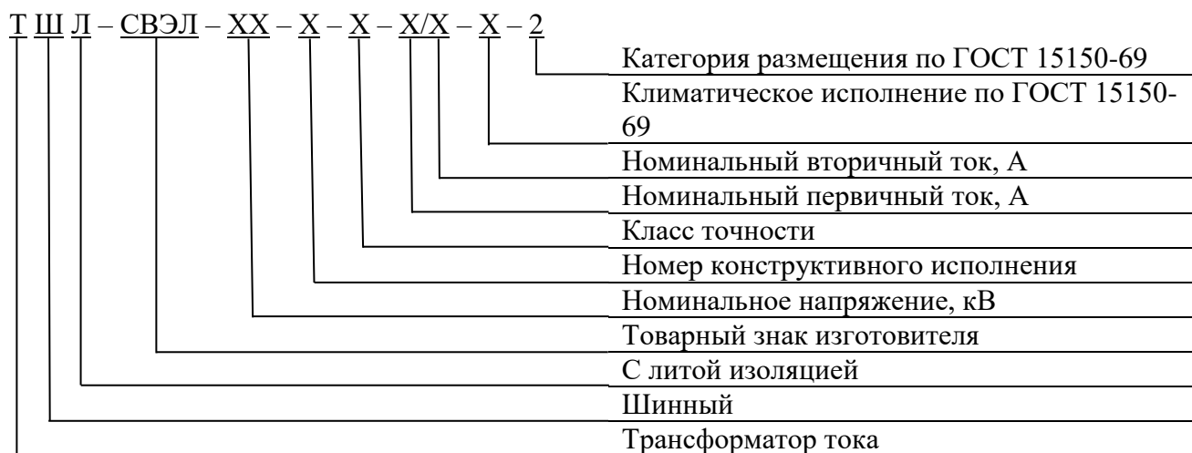
Рисунок 4 – Структура условного обозначения трансформаторов тока ТШЛ-СВЭЛ
