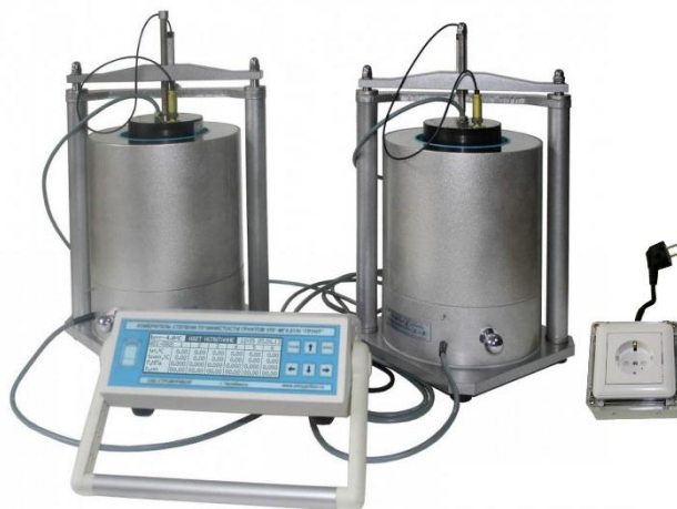
Рисунок 1 – Общий вид измерителя УПГ-МГ4.01/Н «Грунт» с двумя тероконтейнерами
