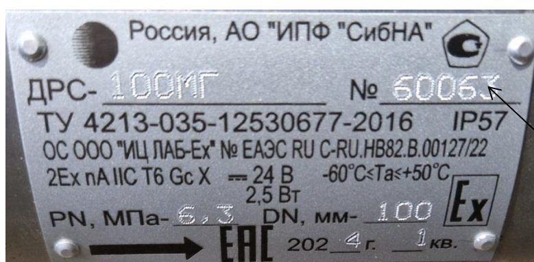
Рисунок 4 – Схема пломбировки от несанкционированного доступа, обозначение места нанесения знака поверки датчиков расхода ДРС
