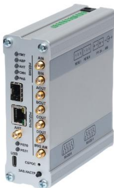
в) Вид сервера в металлическом корпусе для установки на DIN рейку
