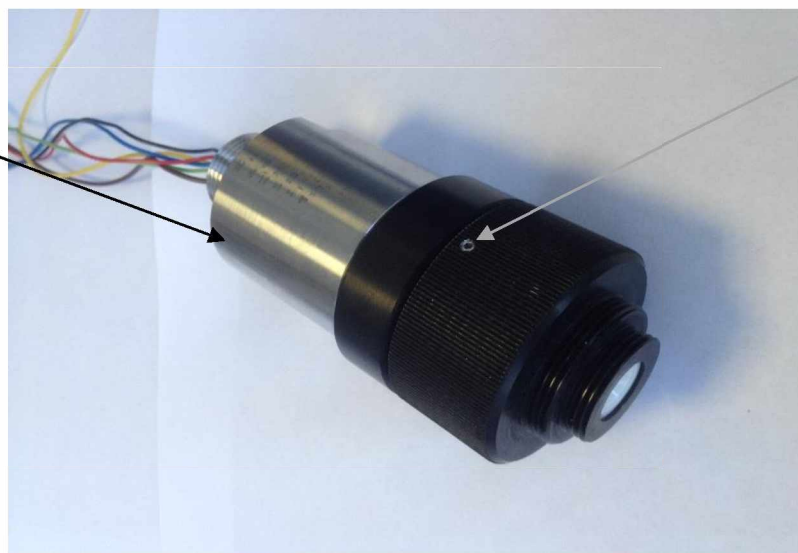
Рисунок 1 – Общий вид преобразователя газоаналитического универсального ПГУ-А без цифрового табло, схема пломбировки от несанкционированного доступа, обозначение места нанесения знака поверки
