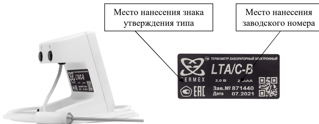
Рисунок 1 – внешний вид термометра с дискретным входом/выходом и двумя каналами измерений температуры: канал 1 — датчик с разъемным соединением, подключенный непосредственно к электронному блоку; канал 2 — датчик с разъемным соединением, подключенный к электронному блоку с помощью кабеля-удлинителя
